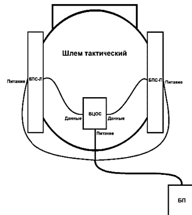
Рис. 2. Схематическое расположение блоков устройства на тактическом шлеме
