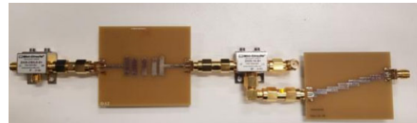
Рис. 2. Физическая версия схемы с одним кубитом, которая включает в себя два смесителя на основе миниатюрных схем и цифровые и параллельные геометрические фильтры для первого и второго каскадов соответственно
