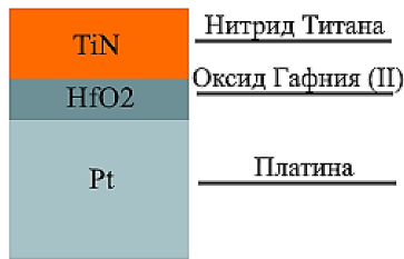
Рис. 2. Структура используемого мемристора
