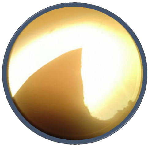
Рис. 2. Износ зубьев фрезы
