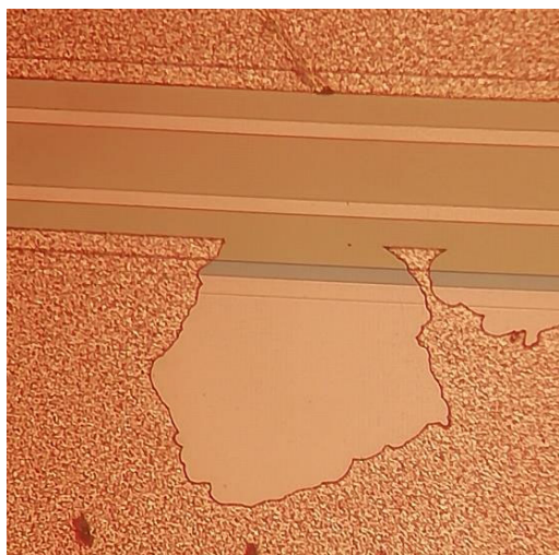
Рис. 3. Пример дефекта «обрыв проводника» на оптическом снимке
