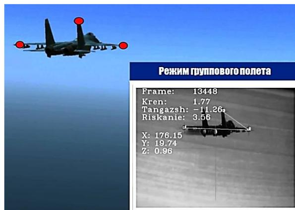
Рис. 2. Определение координат самолета по трем идентичным инфракрасным маякам, расположенным на оптически контрастных элементах конструкции летательного аппарата
