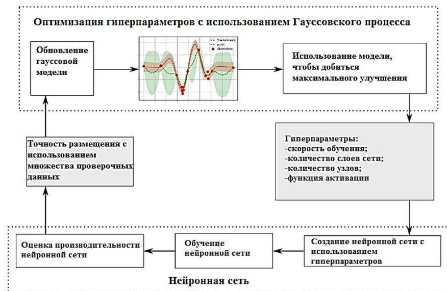
Рис. 8. Блок-схема поведения оптимизации гиперпараметров в гауссовом процессе
