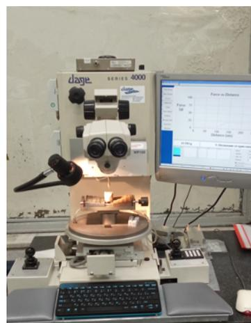
Рис. 2. Установка Dage 4000Plus
