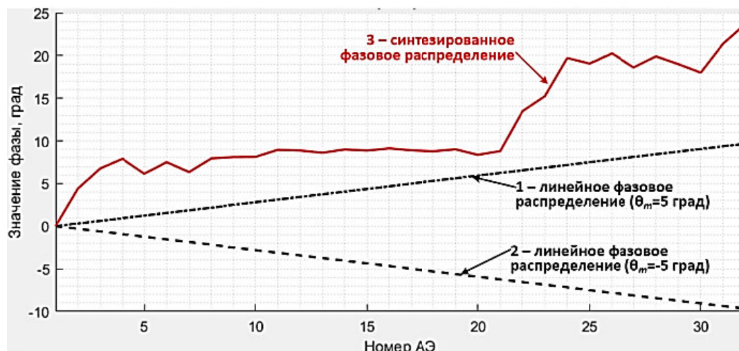
Рис. 3. Закон изменения ФР на раскрытии апертуры АР: 1 – линейное ( \theta_m = 5^\circ ); 2 – линейное ( \theta_m = -5^\circ ); 3 – синтезированное ФР
