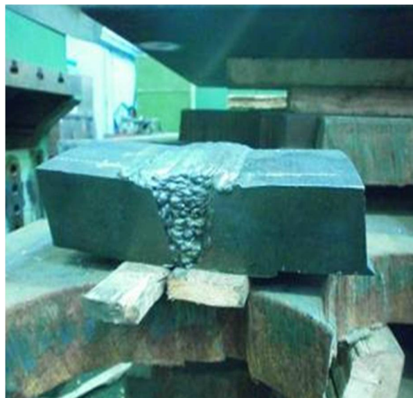
Рис. 1. Модельное композитное сварное соединение
