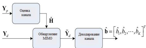
Рис. 2. Блок-схема линейного MIMO-приемника
