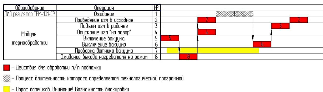
Рис. 5. Циклограмма модуля термообработки
