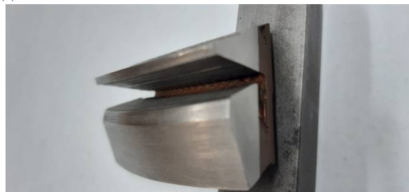
Рис. 4. Сварное соединение огневой стенки камеры ЖРД
