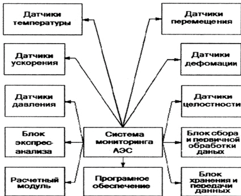
Рис. 2. Структурная схема системы многопараметрического непрерывного мониторинга
