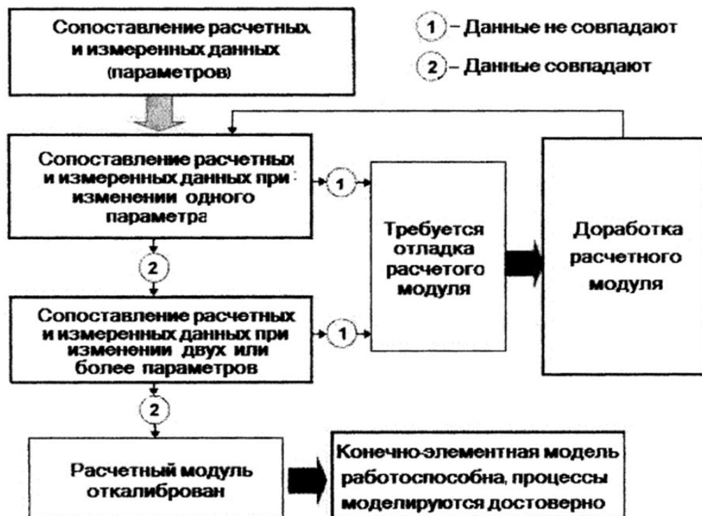
Рис. 3. Алгоритм калибровки трехмерной конечно-элементной модели
