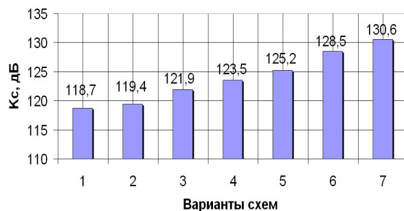
Рис. 10. Результаты подавления синфазных сигналов различными вариантами схем
