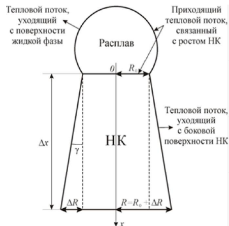
Рис. 2. Схема тепловых потоков, возникающих в процессе роста НК, и геометрии кристалла
