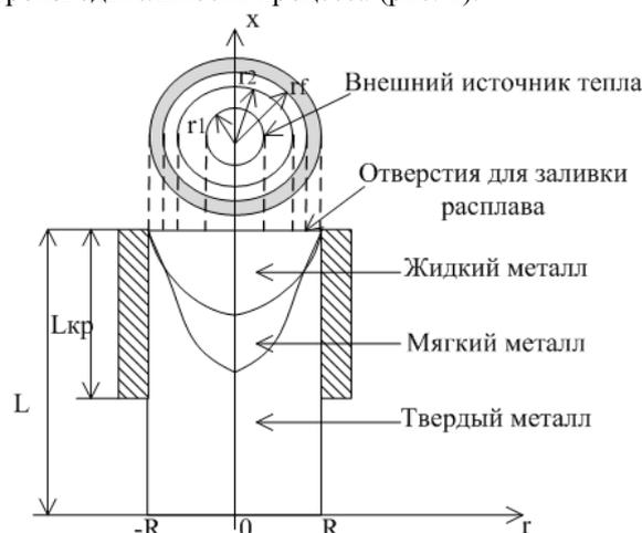
Рис. 1. Принципиальная схема непрерывного литья с вытяжкой заготовки вниз (разрез кристаллизатора в продольном и поперечном сечении):  $R$  – радиус формы,  $L$  – длина формы,  $L_{кр}$  – длина кристаллизатора,  $r_1, r_2$  – внутренний и внешний радиусы кольца, через которое осуществляется дополнительный подогрев,  $r_f$  – внутренний радиус кольца для литья
