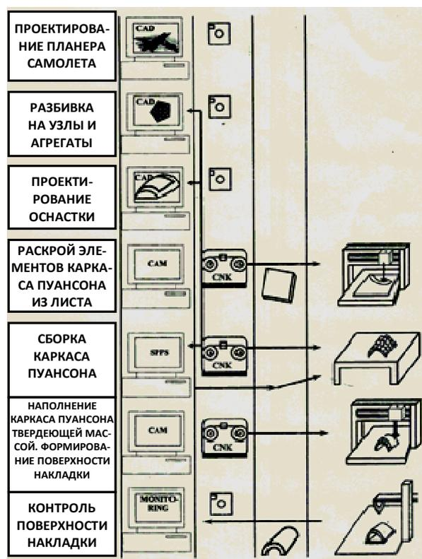
Рис. 4. САПР технологического процесса изготовления криволинейной накладки универсального пуансона
