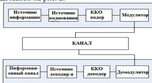
Рис. 2. Модель связи с кодом, корректирующим ошибки
