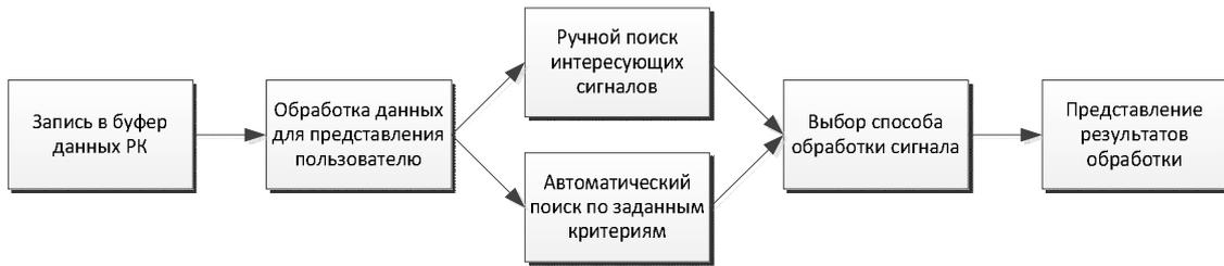
Рис. 1. Типовой алгоритм обработки сигналов с использованием буфера данных
