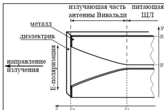
Рис. 1. Конструкция антенны Вивальди для частоты 1-2 ГГц [2]
