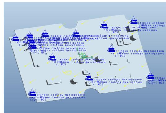
Рис. 5. Пятый вариант конструкции закреплено 10 отверстий и 3 светодиода
