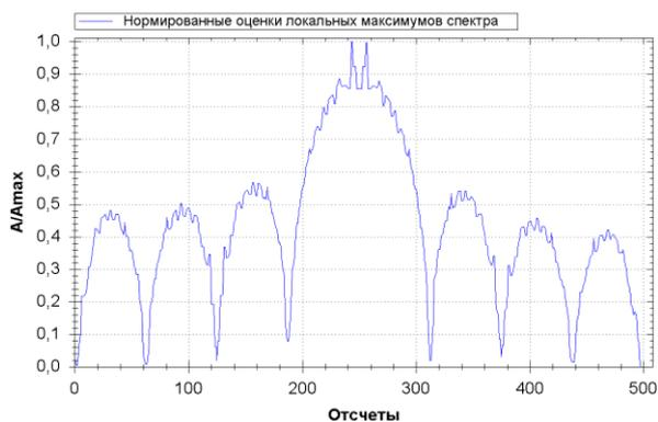
Рис. 5. Оценки отсчетов спектра РЛС сигнала (ФКМ модуляция, М-последовательность (длина последовательности  $N = 63$ ), НЧПИ)
