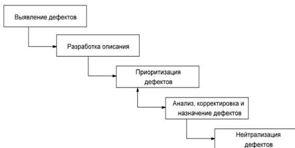
Рис. 1. Функциональная схема жизнедеятельности дефектов
