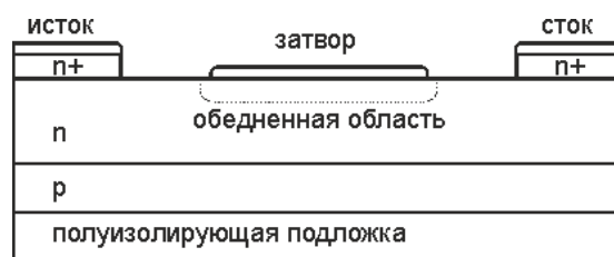
Рис. 1. Схематичное изображение конструкции MESFET SiC-транзистора
