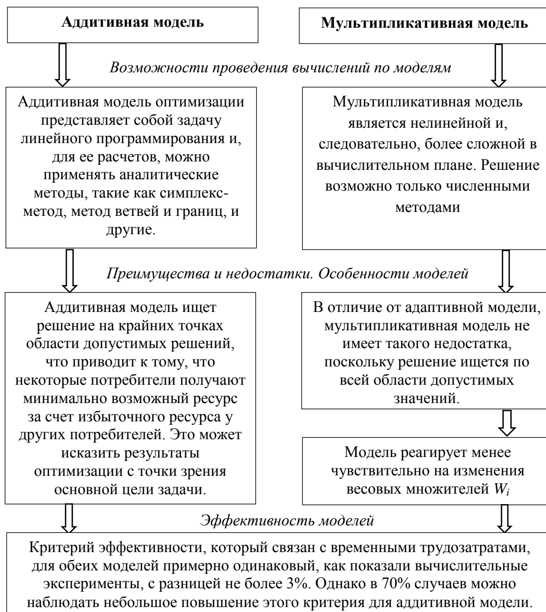
Рис. 2. Сравнение аддитивной и мультипликативной моделей
