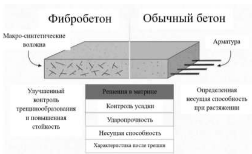
Рис. 1. Схема распределения фибр в объеме бетонной матрицы в сравнении с обычным бетоном
