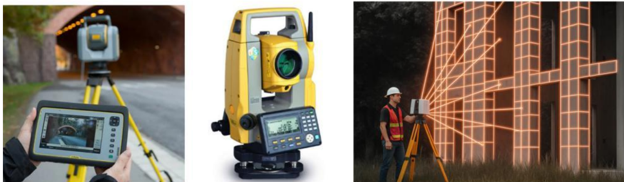
Рис. 1. Приборы по натурным обмерам тахеометры и лазерный 3D-сканер
