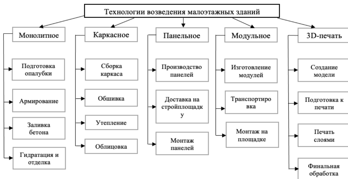
Рис. 3. Этапы технологий возведения малоэтажных зданий
