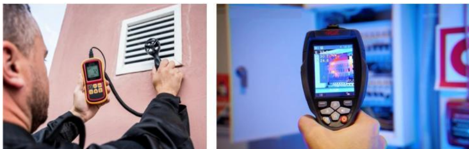
Рис. 4. Замер расхода воздуха системы вентиляции и мониторинг тепловых потерь
