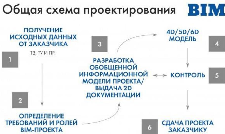
Рис. 1. Общая схема проектирования BIM [1]
