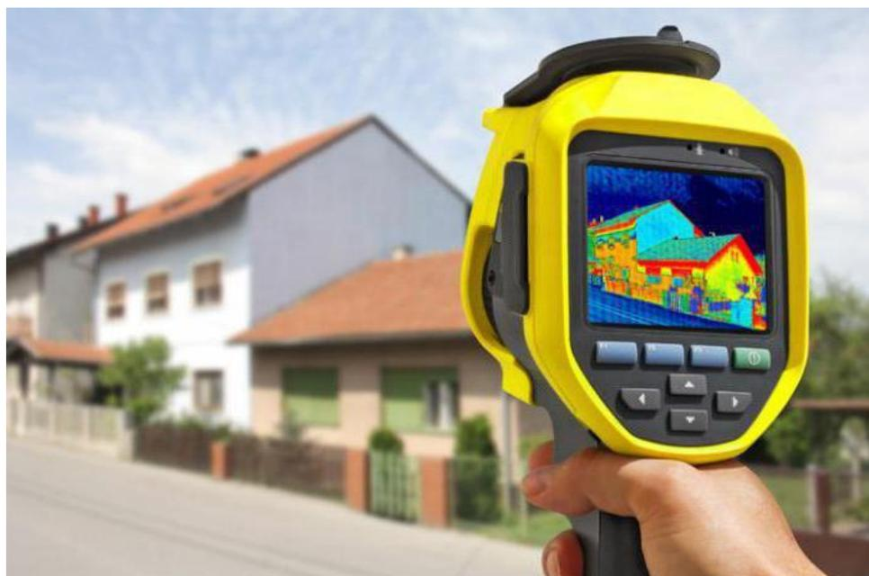
Рис. 2. Измерение теплотерь жилого дома тепловизором [5]
