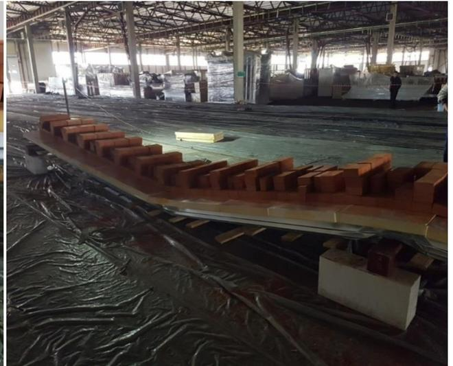
Рис. 9. Истощение несущей способности профлиста в середине пролета при нагрузке на профлист в 1.96кН/м (705 кирпичей)
