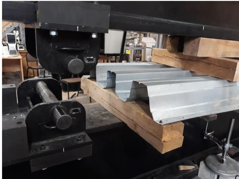
Рис. 6. Исчерпание несущей способности профлиста на опоре при давлении прессы в 13.41 кН
