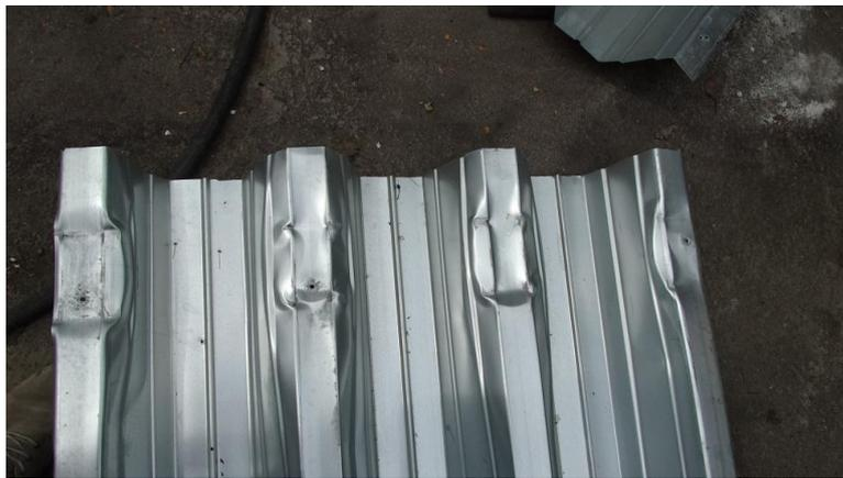
Рис. 3. Вырезанный фрагмент обрушившегося листа. Видно смятие на средней опоре с местной потерей устойчивости стенки
