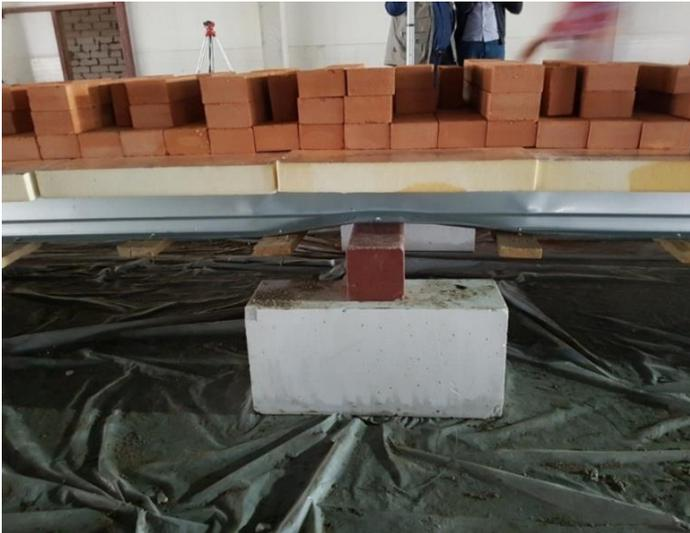
Рис. 8. Потеря устойчивости стенки на средней опоре при нагрузке на профлист в 1.53кН/м (549 кирпичей)
