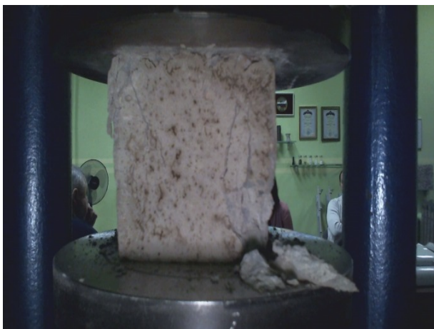
Рис. 2. Характерное разрушение образцов со шлифованными торцами (эталонные образцы)
