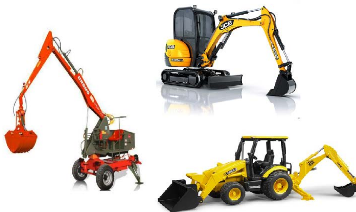
Рис. 5. Машины и механизмы для разработки и удаления грунта из котлована
