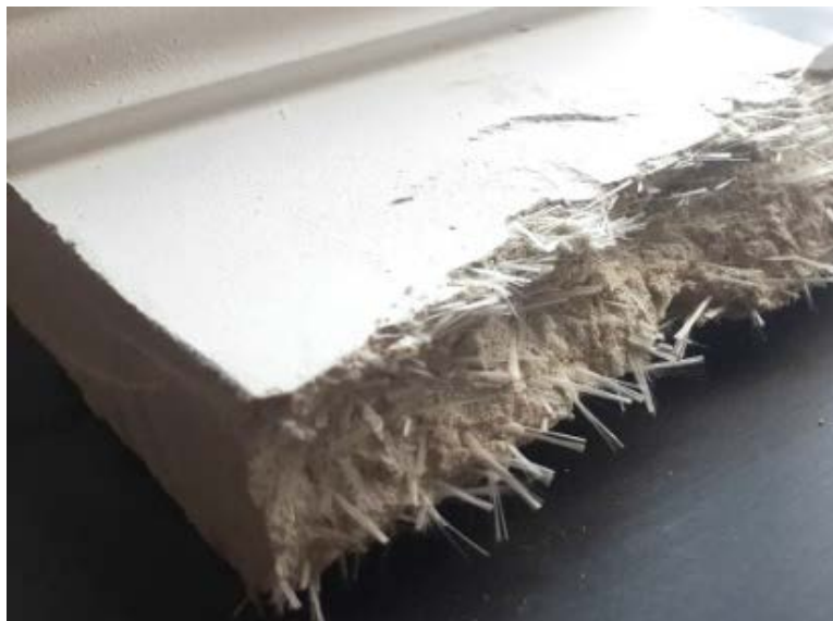
Рис. 2. Разрушенный фибробетон после испытаний на изгиб
