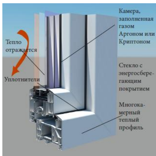
Рис. 1. Схематическая иллюстрация увеличения степени теплозащиты окон и балконных дверей [8]
