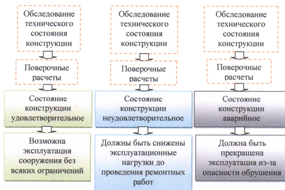
Рис. 2. Алгоритм оценки степени техсостояния несущих систем
