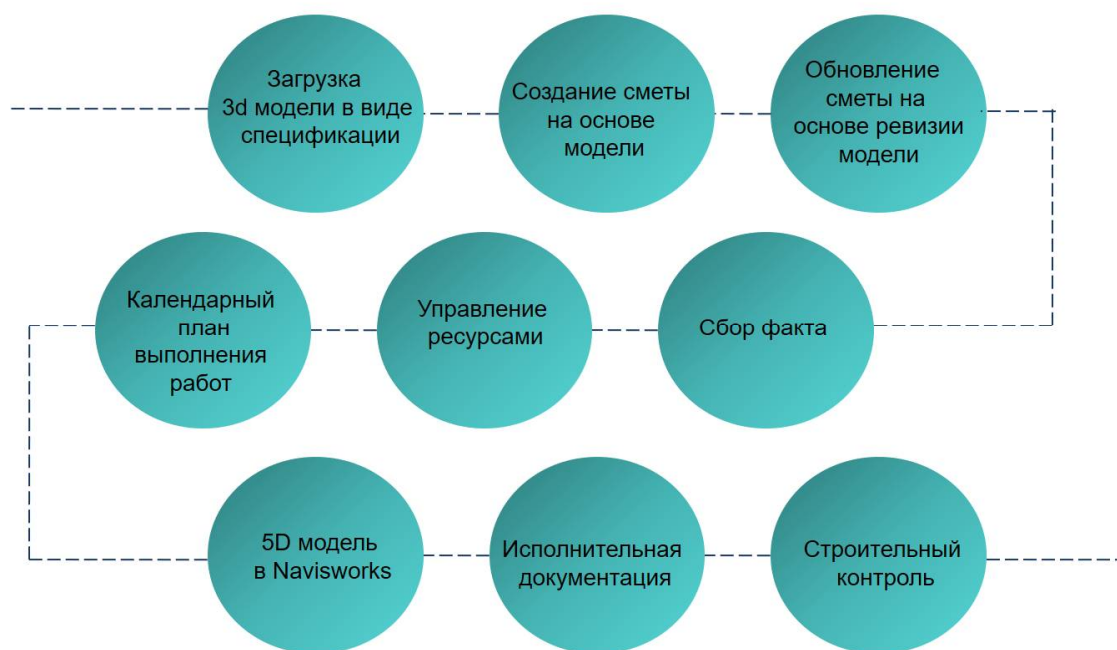
Рис. 1. Управление за процессом проектирования и строительства в цифровом формате (исполнительная документация на стройке 6D)
