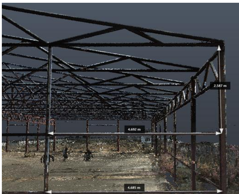
Рис. 1. Оценка геометрических параметров металлической конструкции на облаке точек
