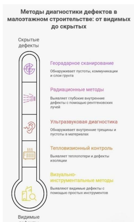
Рис. 1. Схема методов диагностики дефектов в малоэтажном строительстве
