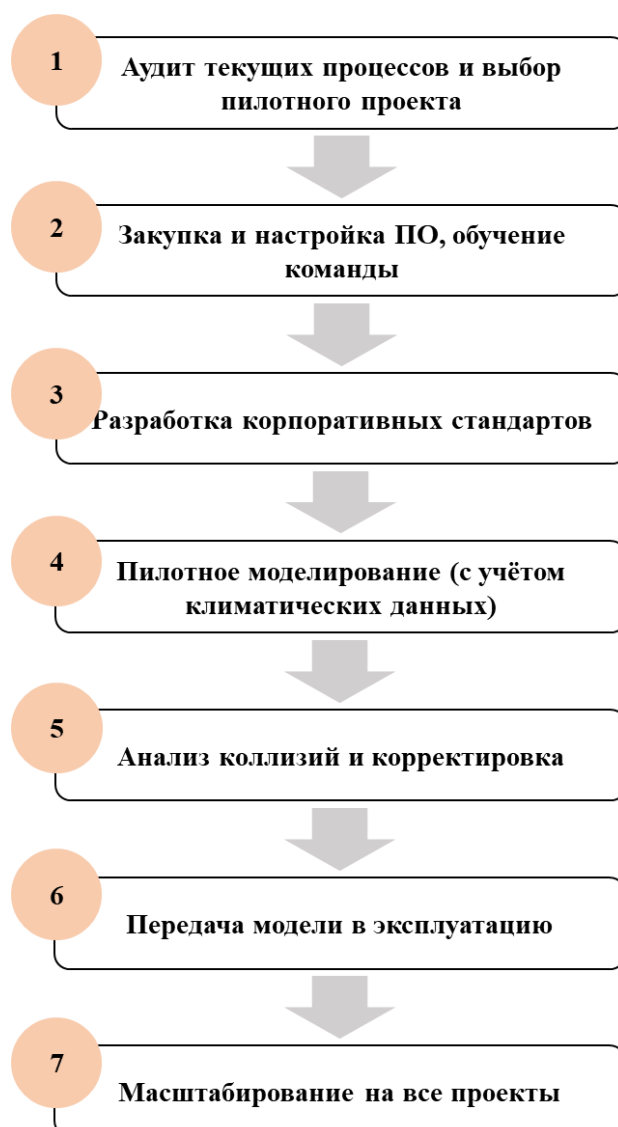
Рис. 2. Блок-схема поэтапного внедрения сквозного BIM в строительной организации (для арктических проектов)
