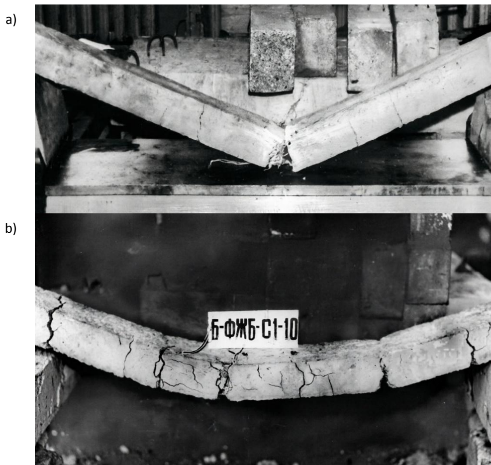
Рис. 4. Характер разрушения балок: (а) - без фибрового армирования (хрупкое разрушение); (б) - с фибровым армированием (вязкое разрушение)
