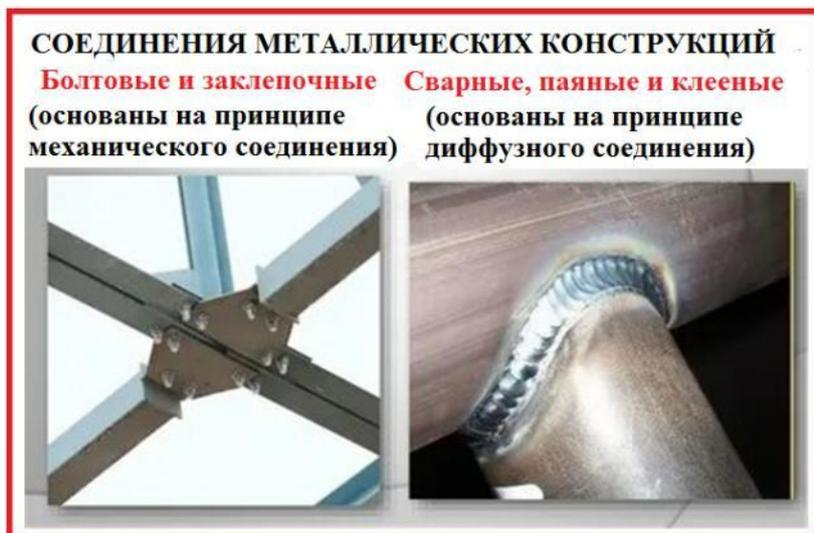
**Рис. 1. Виды соединения конструкций**
