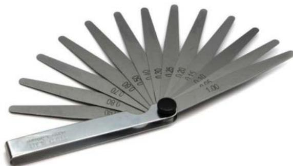
**Рис. 3. Набор измерительных щупов**
