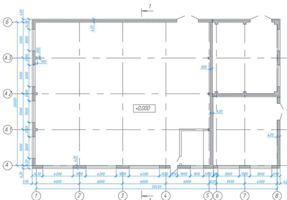
**Рис. 1. План котельной на отм. +0,000**
