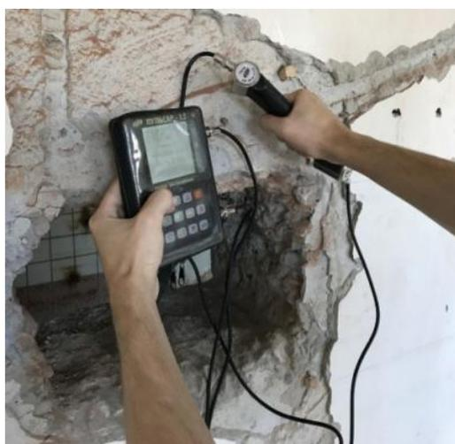
**Рис. 3. Определение прочности и плотности бетона ультразвуковым прибором**
