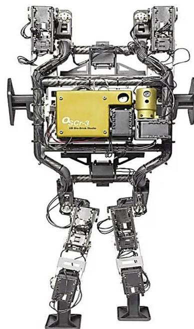
Рис. 1. Робот-носильщик OSCR-3
