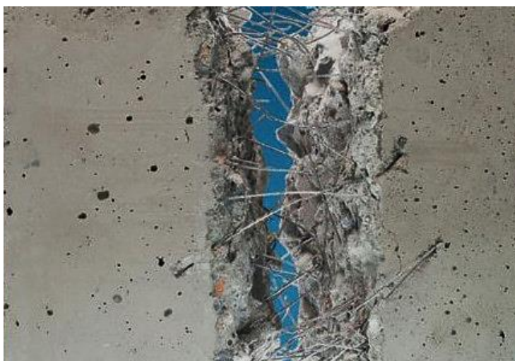
Рис. 1. Армирование бетона фиброволокном
