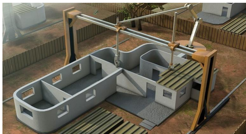
Рис. 2. Модель порталного 3D-принтера Contour Crafting
