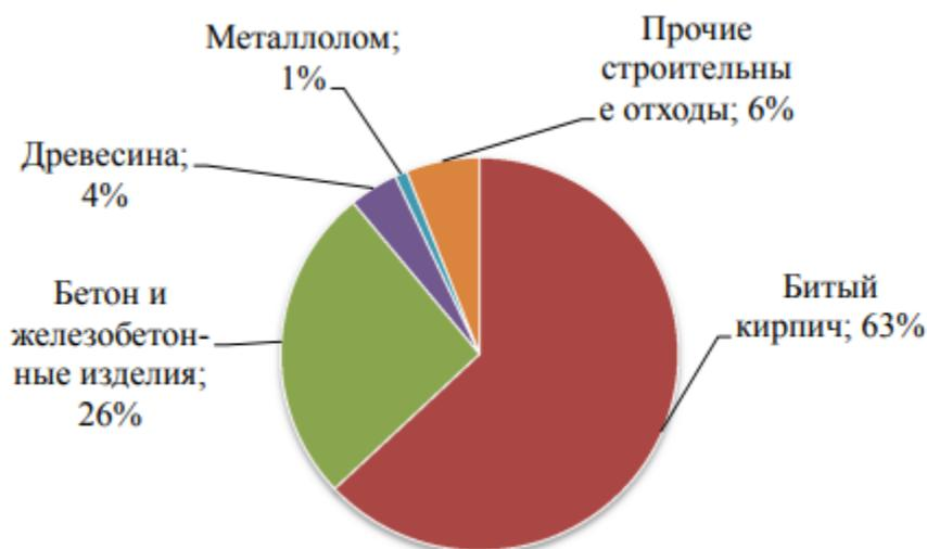
**Рис. 1. Виды строительных отходов**
