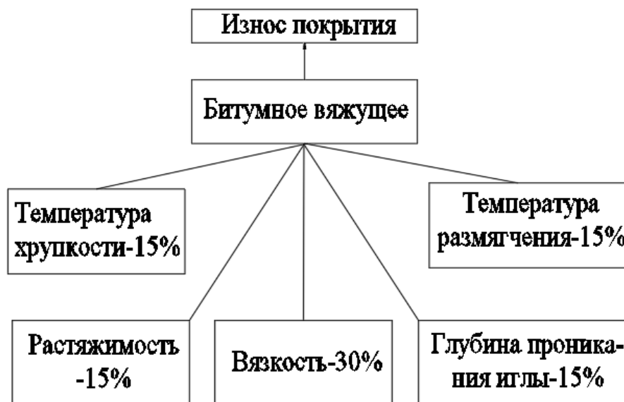
Рис. 3. Схема основных технических характеристик битумного вяжущего
