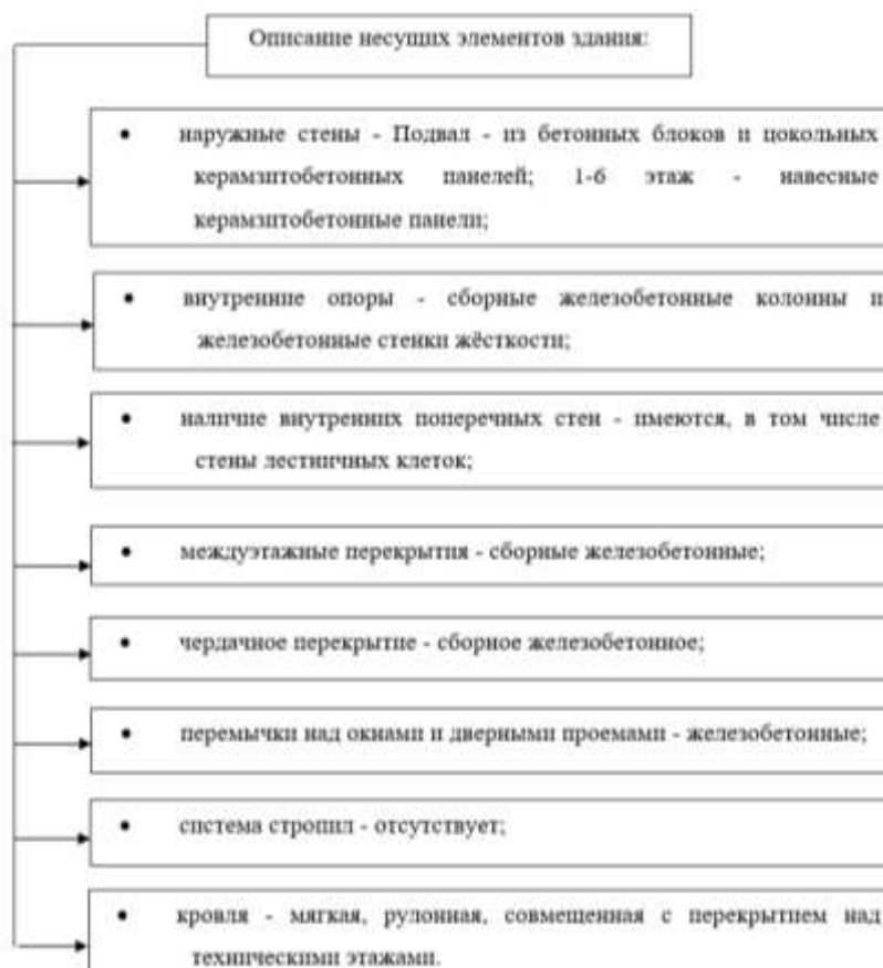
Рис. 1. Описание несущих элементов здания
