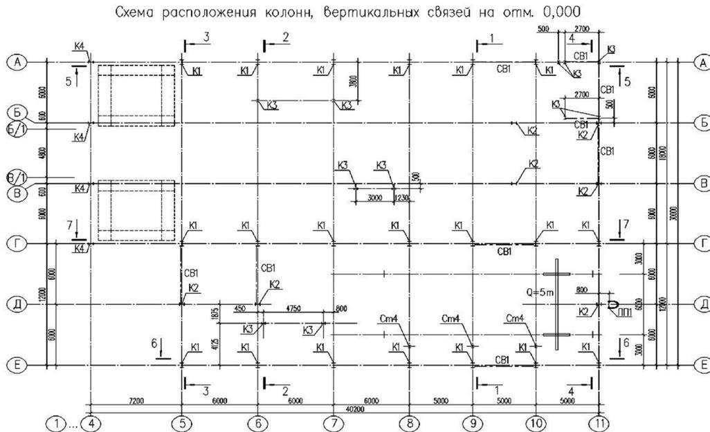
Рис. 1. План расположения несущих элементов производственного здания
