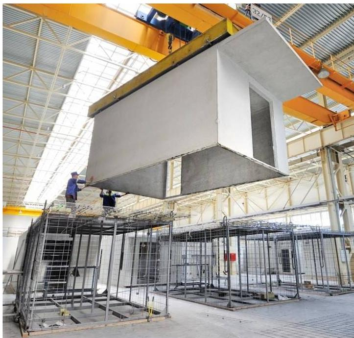
**Рис. 1.** Конструкция объемного блока «Выбор-ОБД»
