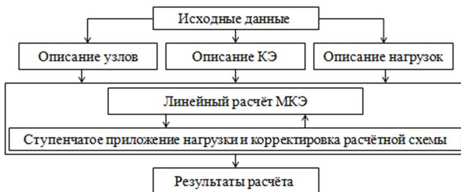
**Рис. 9.** Структурная схема программы расчёта МКЭ мостовых устоев и подпорных стенок из ШТС
