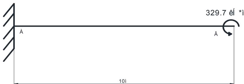
Рис. 4. Чистый изгиб консольного стержня
