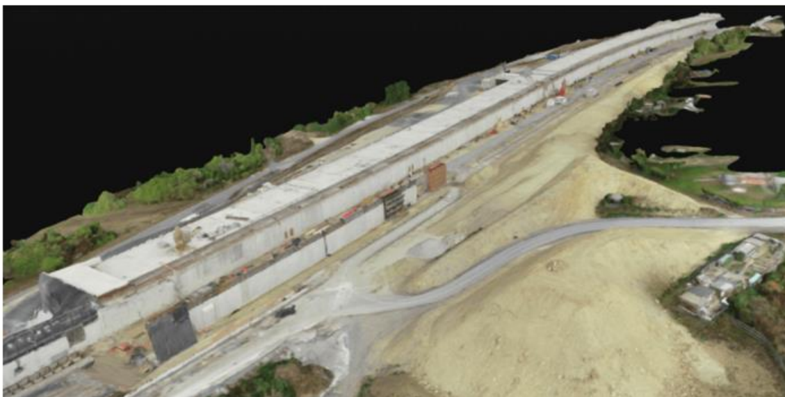
Рис. 3. Модель объекта, полученная съемкой с дрона
