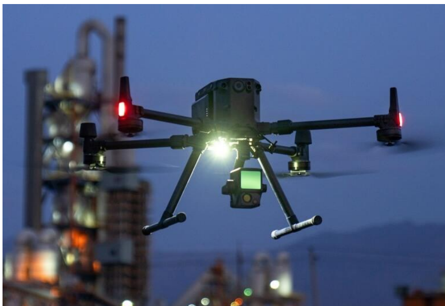
Рис. 1. Квадрокоптер DJI Matrice 300 RTK в комплекте с LiDAR DJI Zenmuse L1
