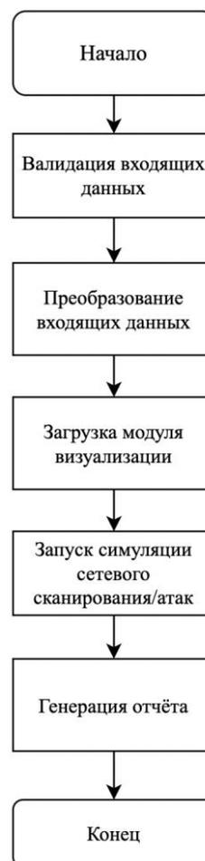
Рис. 3. Блок-схема работы «бэкенд-компонента»
