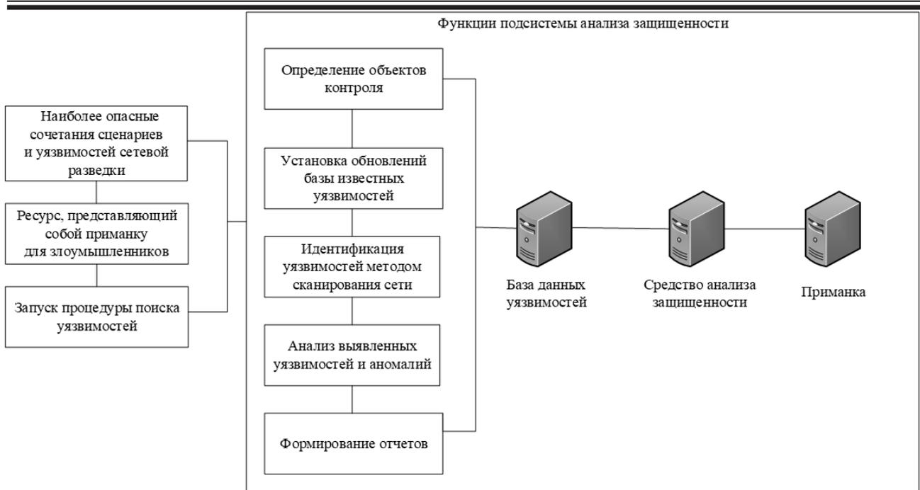
Рис. 5. Функциональная схема Подсистемы 2
