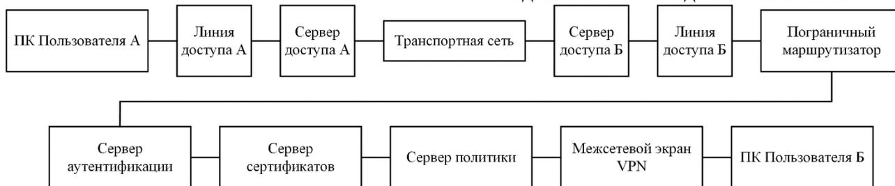
Рис.3.Схематичное представление модели VPN
