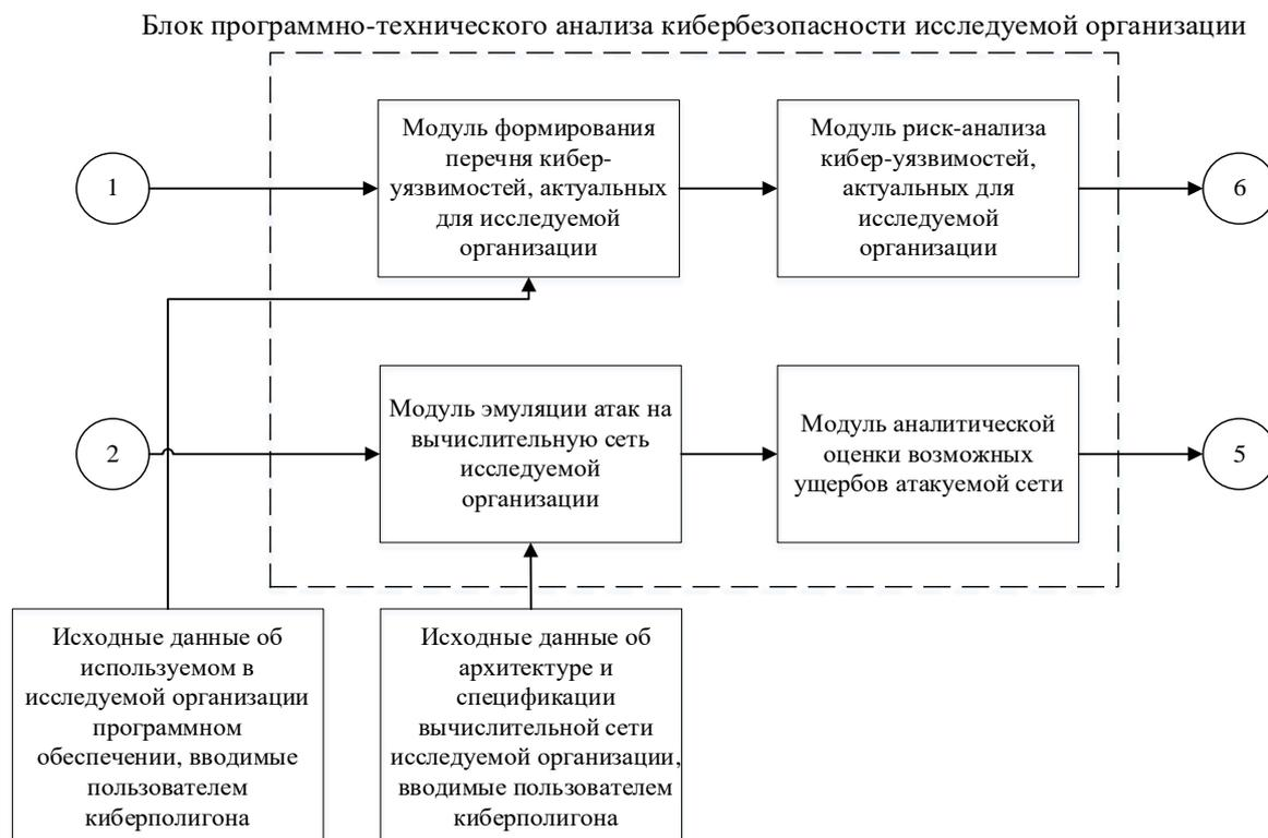
Рис. 2. Схема функционирования блока программно-технического анализа Киберполигона
