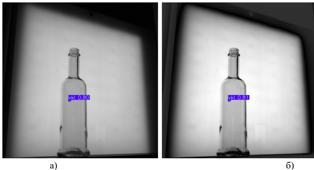
Рис. 5. Сравнение результатов распознавания дефектов тела: а) оригинальное изображение б) изображение с повышенной яркостью и контрастностью
