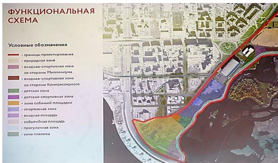
**Рис. 4.** Функциональная схема парка на Крачковых озерах, Казань
