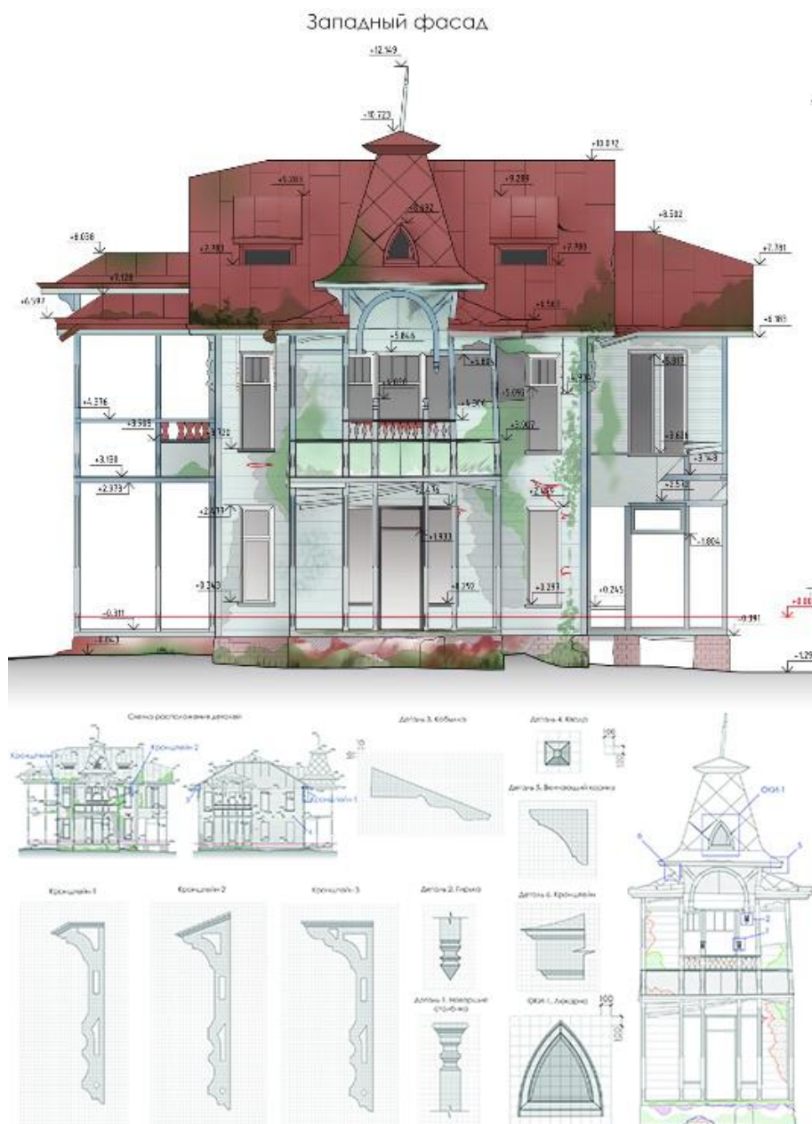
Рис.2. Дача в стиле модерн, Архитектурные обмеры: западный (главный) фасад и детали. Выполнены А.И. Хлебниковой
