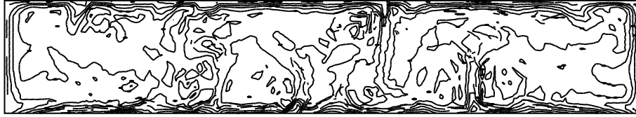
Рисунок 4.41 – Распределение температурного поля в режиме турбулентности
