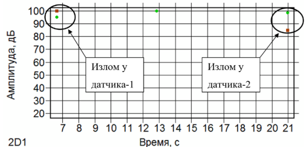
Рисунок 2.2.3 – Результаты калибровки. Интерфейс программного обеспечения. (красный – сигнал с датчика-1, зеленый – сигнал с датчика-2)
