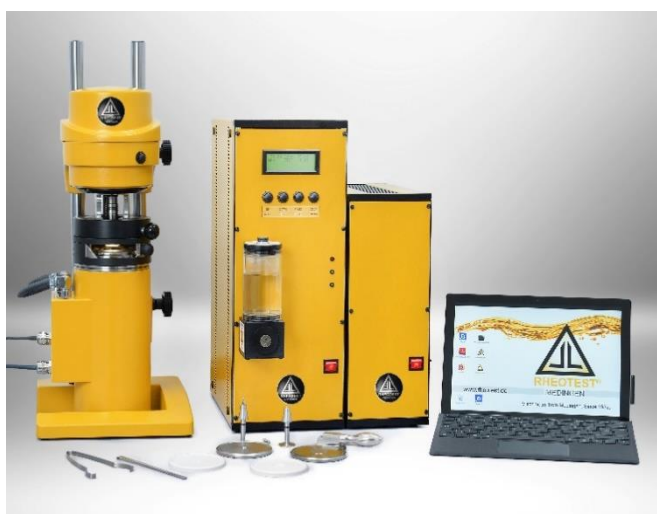
Рисунок 2.1 – Ротационный вискозиметр RHEOTEST 4.1
