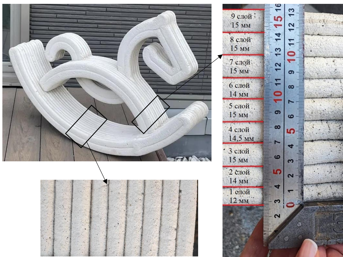
Рисунок 5.3 – Объекты, изготовленные методом экструзионной безопалубочной печати из смесей с заполнителем размером D = 160-1250 мкм
