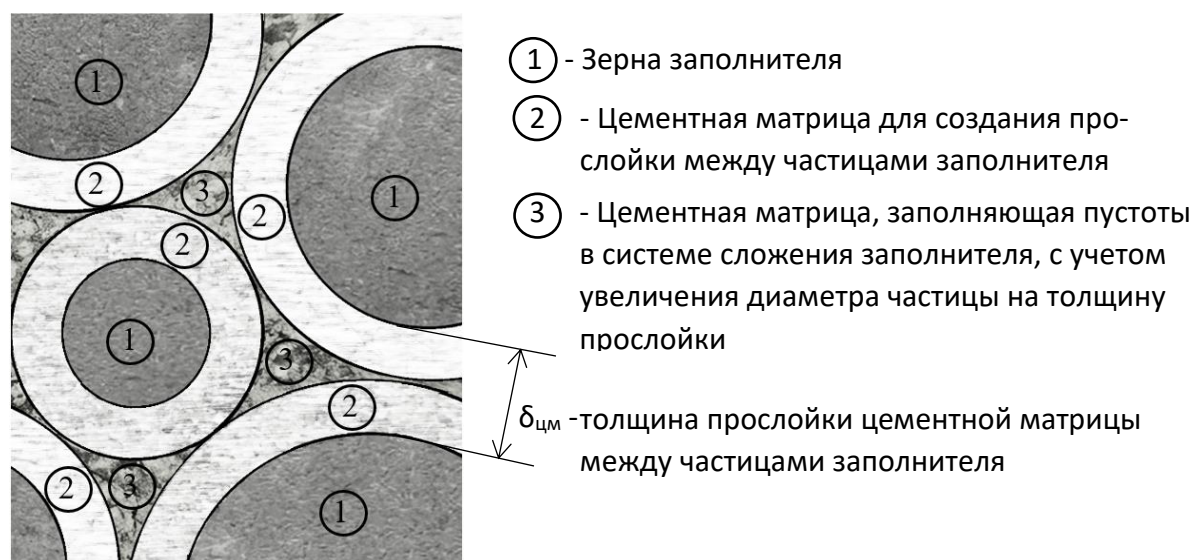
Рисунок 3.5 – Геометрическое представление о структуре сложения двухкомпонентной системы «цементная матрица – зерна заполнителя»
