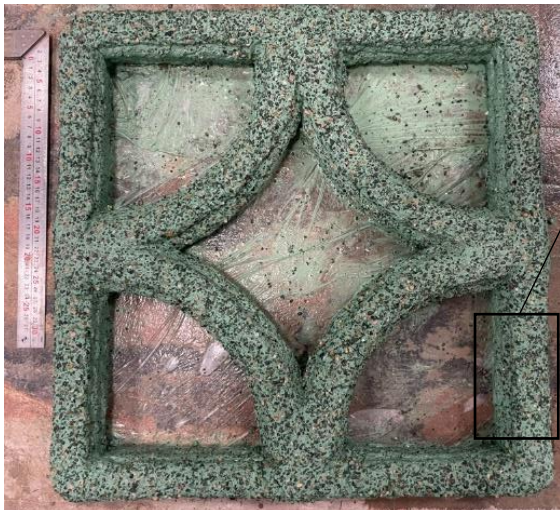
Рисунок 5.4 – Объекты, изготовленные методом экструзионной безопалубочной печати из смесей с заполнителем размером D = 630-5000 мкм
