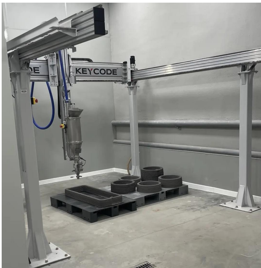
Рисунок 2.1 – Промышленный принтер «KEYCODE» модели «КРАФТЕР-У»
