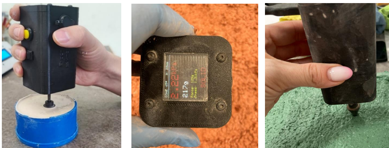
Рисунок 5.2 – Контроль пластичности смеси перед печатью
