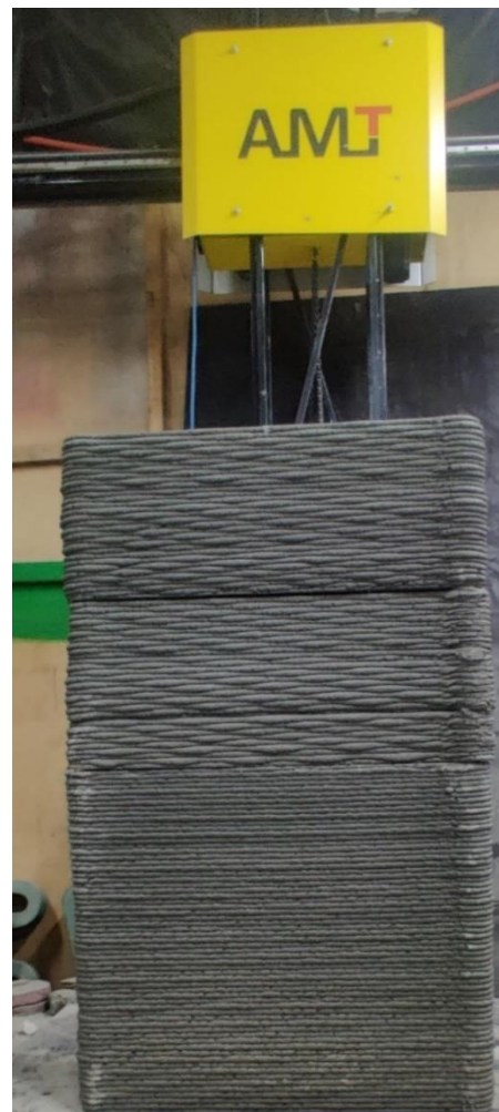
Рисунок 5.2 – Напечатанный натурный объект на прин- тере «AMT» S-6044 LONG
