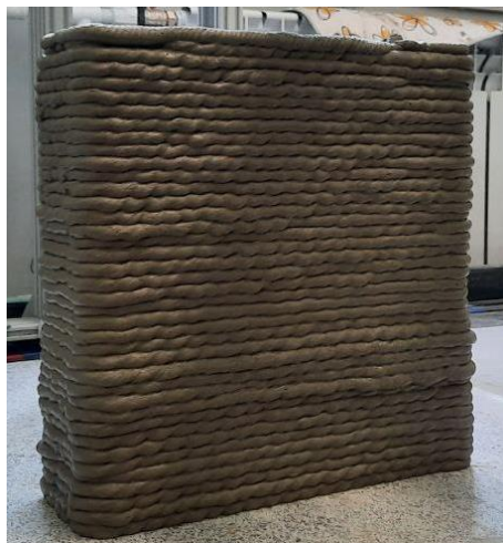
Рисунок 8 – Модельные (а) и полноразмерные элементы (б), полученные при печати смесями с оптимальными технологическими характеристиками
