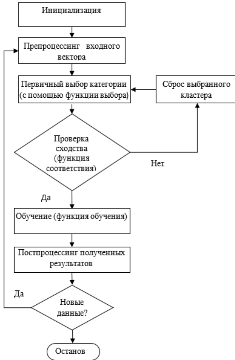
Рис. 2.2. Схема функционирования сети семейства ART.
