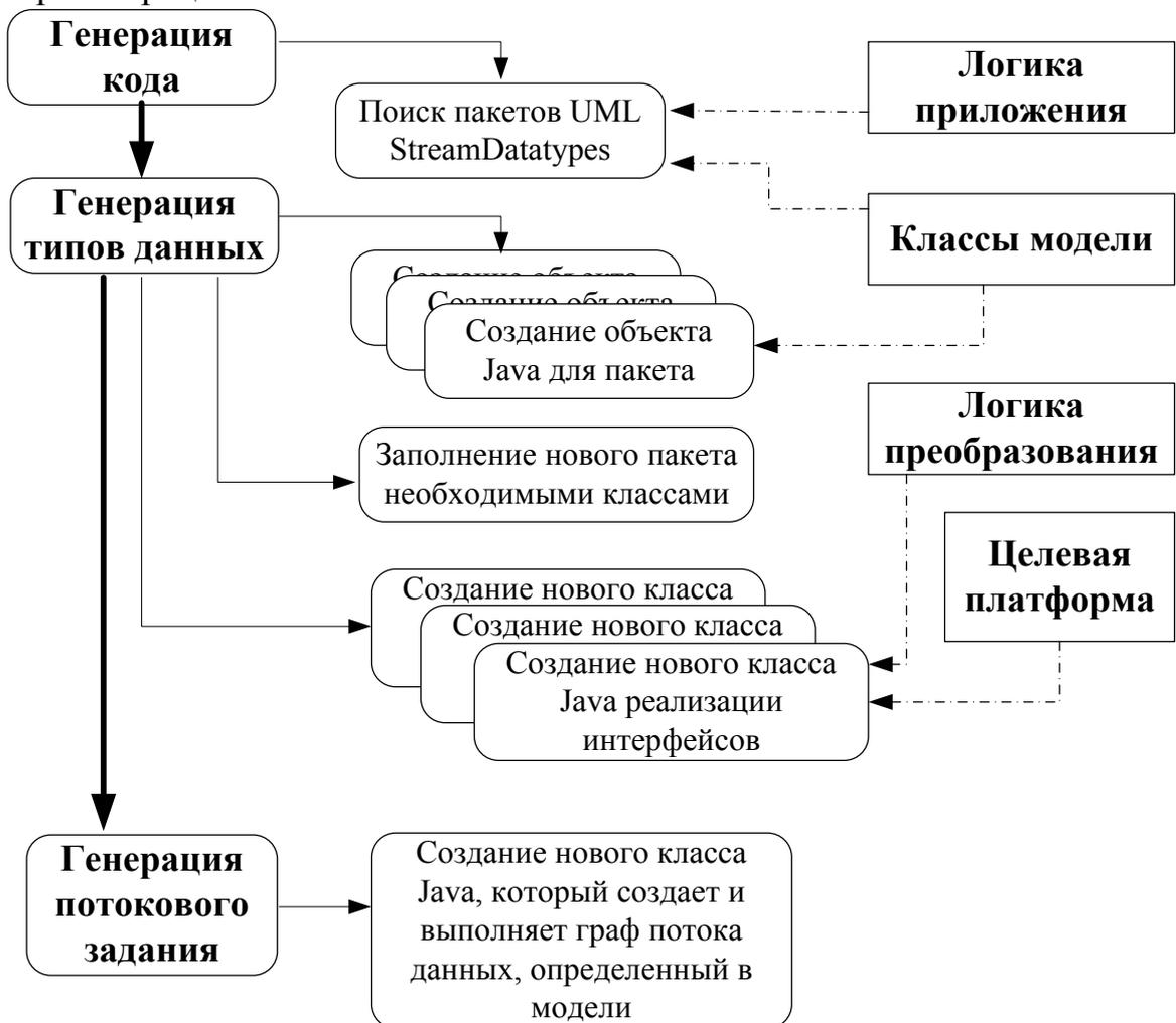
Рис. 6. Структура программного прототипа системы разработки потоковых приложений для обработки данных на основе моделей потоков данных
